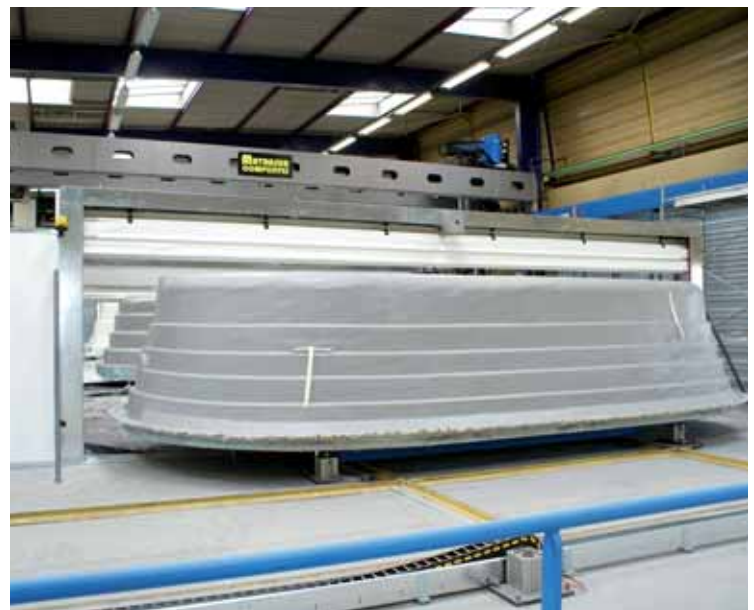
Coque en fin de chaîne de fabrication automatique, après le dernier stade de l'étuvage (Ibiza Piscines).
