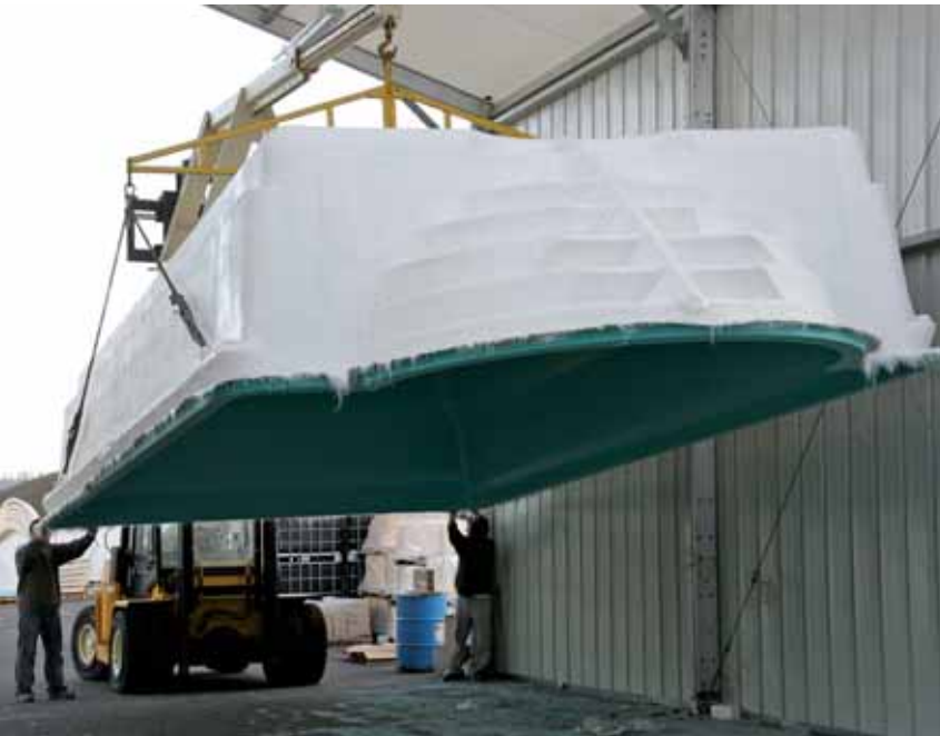
Coque en fin de chaîne de fabrication automatique, après le dernier stade de l'étuvage (Ibiza Piscines).
