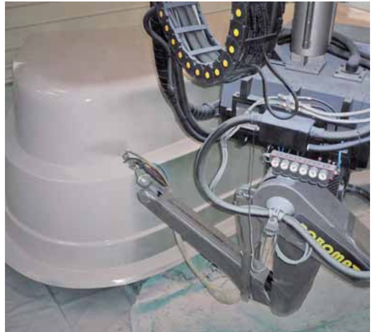
Dans certaines usines, ce sont des robots qui appliquent le gel-coat et gèrent les projections simultanées de polyester et de fibres de verre (Ibiza Piscines).
